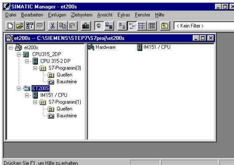
45. Zuerst wird nun die ET200S/CPU auf RUN geschaltet. Ist diese angelaufen, so wird durch Schalten des Schlüsselschalters auf RUN auch in der CPU 315-2DP das Programm gestartet.
