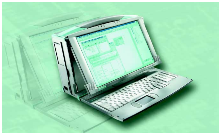
Bild 2: Power PG mit geschwenktem Display und aufgestellter Tastatur
