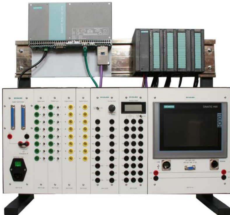
Abbildung Schulungsgerät W4748-1D mit SIMATIC PCS7 Box in Rackform
